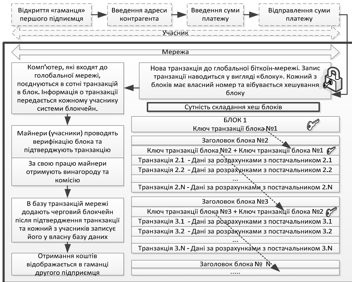
Рис. 1. Принцип роботи технології Blockchain
