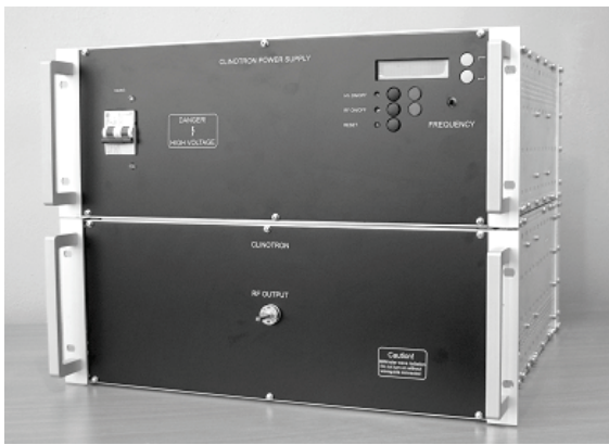
Рис. 4. Комплексированное устройство, содержащее пакетированный с магнитом генераторный клинотрон, компактный источник питания, автономную систему принудительного жидкостного охлаждения, систему контроля и управления работой генератора на основе компьютера
