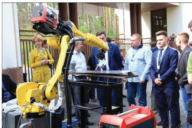
Демонстрация сварочного робототехнического комплекса с системой технического зрения
