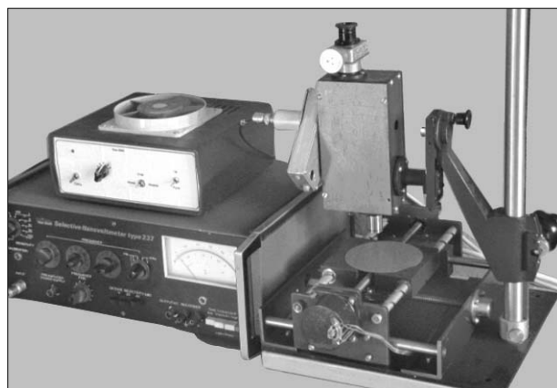
Рис. 2. Лазерний тензометр для вимірювання просторового розподілу та величини механічних напружень в матеріалах
