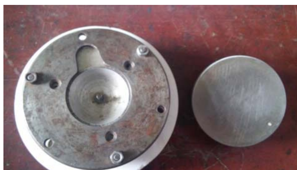
Рис. 2. Вариант стационарной РК с крышкой – электродом, расположенным рядом
