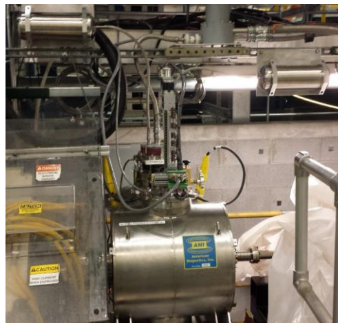
Рис. 3. Новый сверхпроводящий магнит и мишень поляриметра
