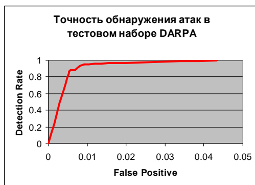
Рис. 8. Точность обнаружения атак методом выявления аномалий в эталонном наборе данных DARPA 1999
