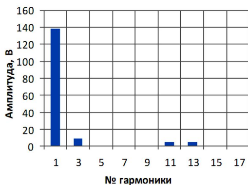
Рис. 5. Высшие гармоники ЭДС СДПМ в режиме холостого хода
