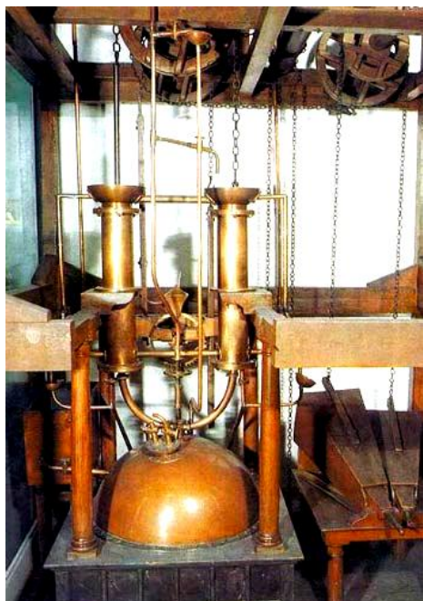
Рис. 9. Макет паровой машины российского изобретателя-механика И.И. Ползунова (современный экспонат краеведческого музея г. Барнаула, Российская Федерация) [9]
