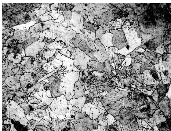
Рис. 8. Структура участка перегрева сварного соединения свежего пара ( \times 160 ). Ресурс 180000 ч. Нарушение сплошности границ зёрен указано стрелками.
