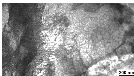
Рис. 6. Дислокационные сплетения в зёрнах \alpha -фазы структуры участка неполной перекристаллизации ЗТВ сварного соединения из стали 12X1MФ ( \varepsilon = 8\% ; начальная стадия развития фрагментарной структуры).
