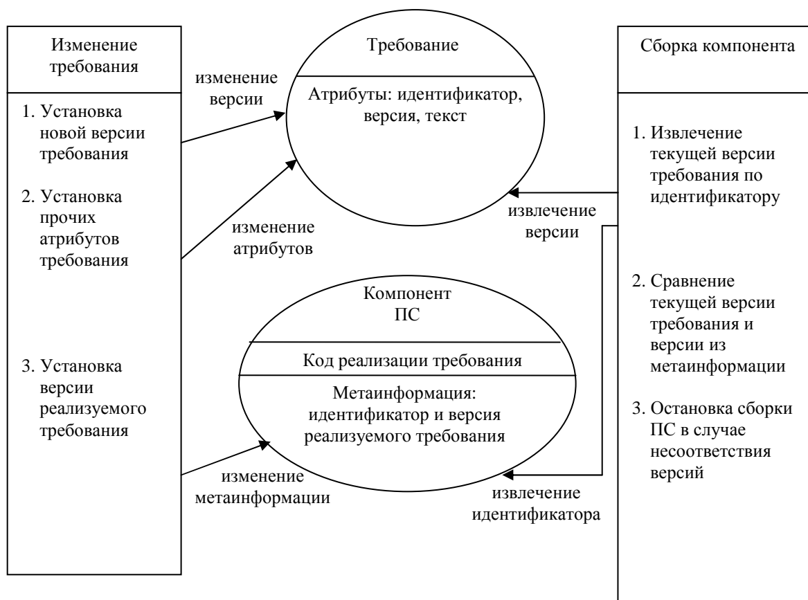
Рис. 4. Пример реализации механизма управляемой сборки компонента
