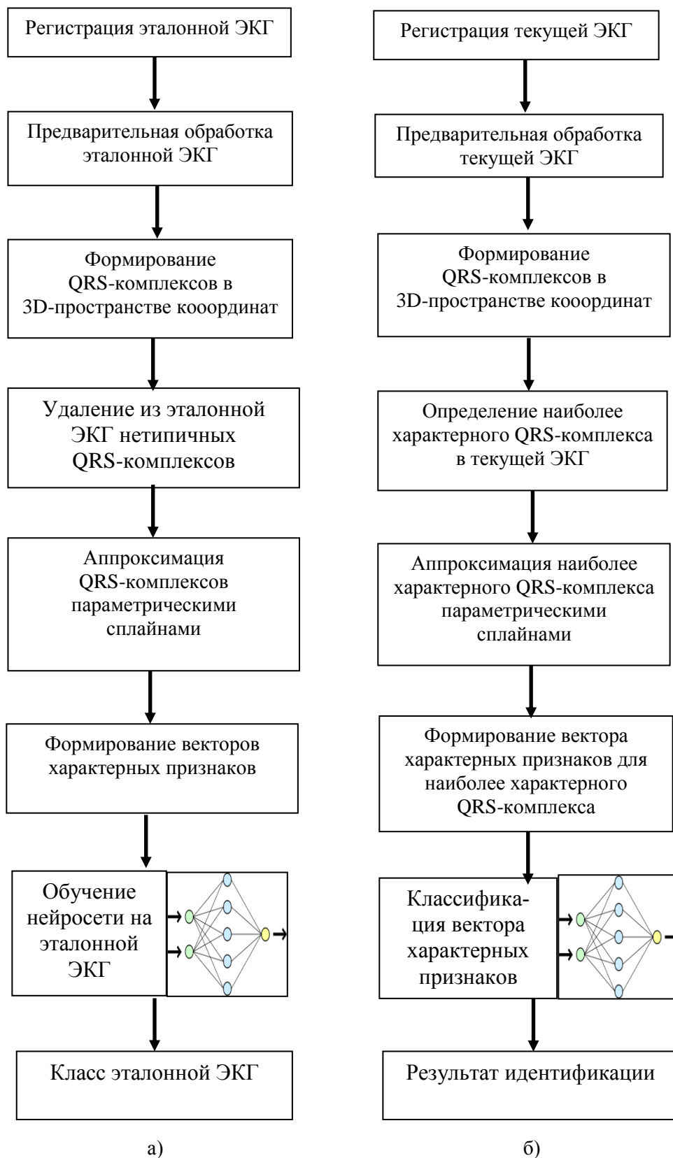
Рис. 4. Схемы обучения нейросети и классификации ЭКГ: а) обучение нейросети на эталонной ЭКГ; б) классификация ЭКГ нейросетью
