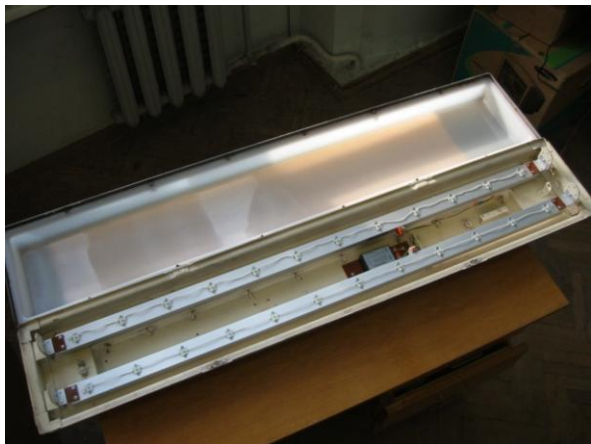
Рис. 11. Внутрішній вигляд світильника для салонного освітлення вагонів метрополітену
