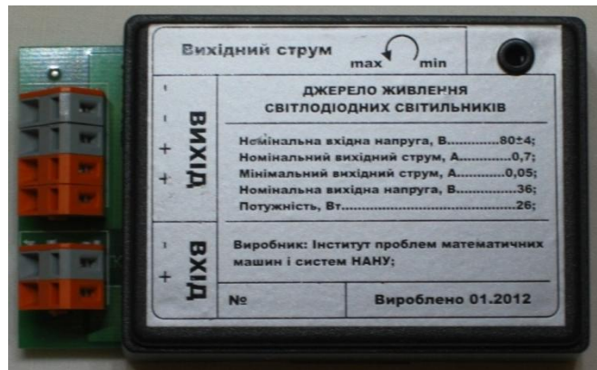
Рис. 4. Друкована плата в корпусі
