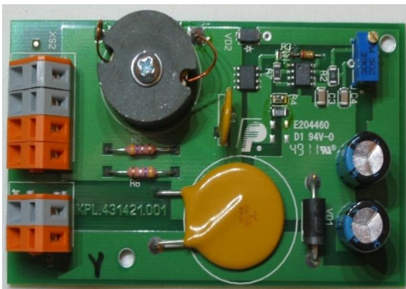
Рис. 3. Джерело живлення на друкованій платі
