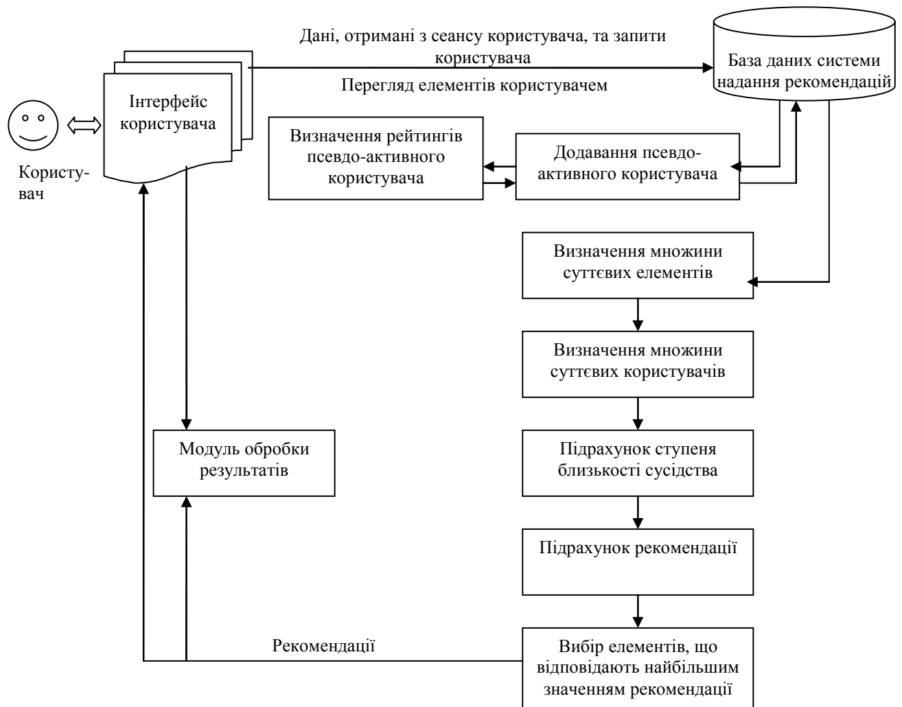
Рис. 3. Схема алгоритму гібридного методу надання рекомендацій
