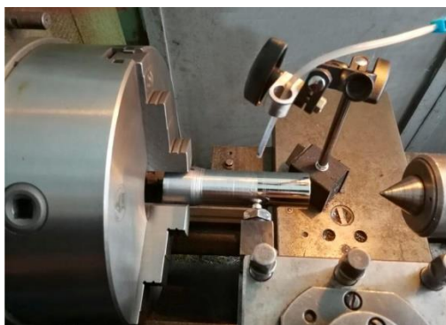
Рис. 4. Заготовка из стали 40Х, закрепленная на универсальном токарном станке С11
