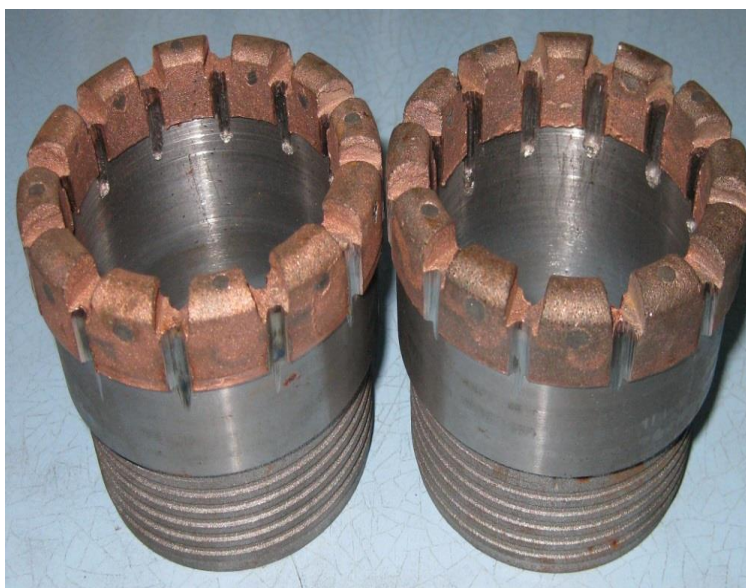
Рис. 1. Опытные буровые коронки типа БТ22
