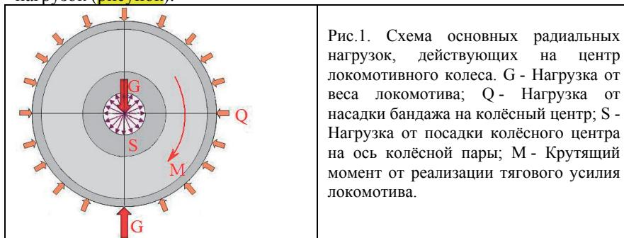
Рис.1. Схема основных радиальных нагрузок, действующих на центр локомотивного колеса. G - Нагрузка от веса локомотива; Q - Нагрузка от насадки бандажа на колёсный центр; S - Нагрузка от посадки колёсного центра на ось колёсной пары; M - Крутящий момент от реализации тягового усилия локомотива.
