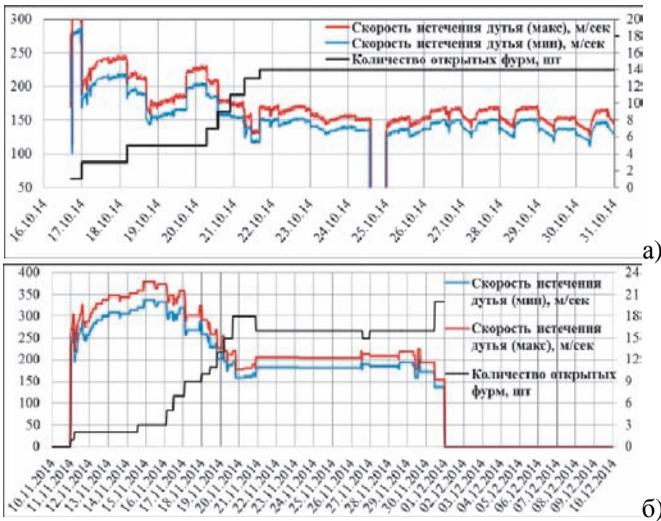
Рис.4а. Скорость истечения дутья из воздушных форм в период задувки и раздувки после длительной стоянки ДП № 5 (а) и ДП № 3 (б)
