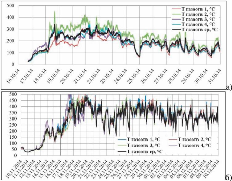
Рис.6а. Изменение температуры колошникового газа (в газоотводах) в период задувки и раздувки после длительной стоянки ДП №5 (а) и ДП №3 (б)
