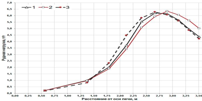
Рис.8. Распределение рудных нагрузок для 3-х вариантов используемых программ загрузки: 1 – с «разгруженной» периферией, 2 – рабочей (базовой) и 3 – с увеличенной долей окатышей
