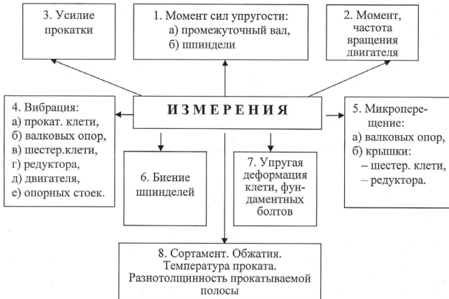
Рис.1. Изменяемые динамические и технологические параметры в клетке широкополосного стана.
