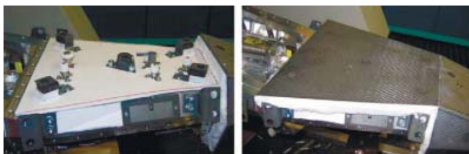
Рис. 1. Панели из композита C/C–SiC фирмы «DLR» с внутренней теплоизоляцией
