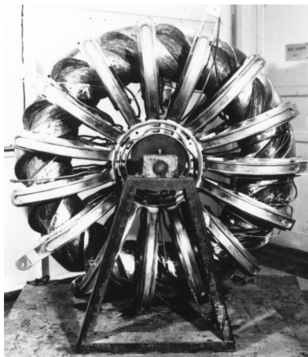
Рис. 12. На винтовую обмотку одеты силовые каркасы
