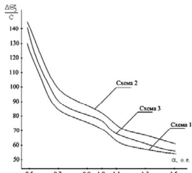
Рис. 5. Термическая характеристика пазовой части обмотки статора  $\Delta\Theta_3 = f(\alpha)$
