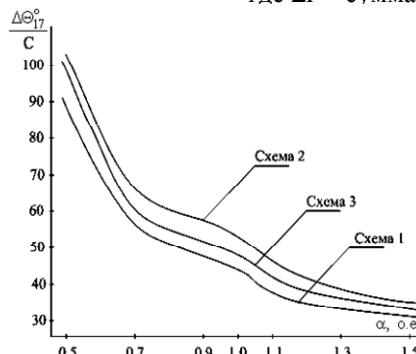
Рис. 6. Термическая характеристика сердечника статора  $\Delta\Theta_{17} = f(\alpha)$
