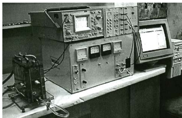
Рис. 13. Общий вид лабораторной установки ИЭД НАНУ для объемного электроискрового диспергирования сплавов
