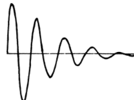
Рис. 6. Сигнал, снимаемый с зонда, при наличии камеры
