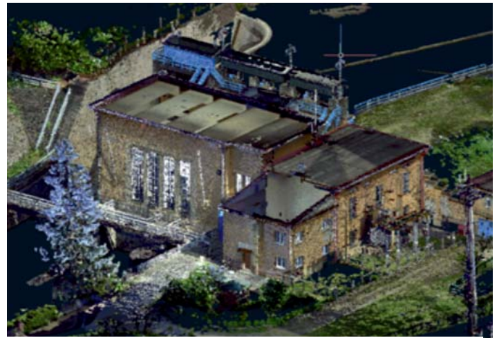
Рис. 7. Точкова модель Оноківської ГЕС, одержана за результатами наземного лазерного сканування
