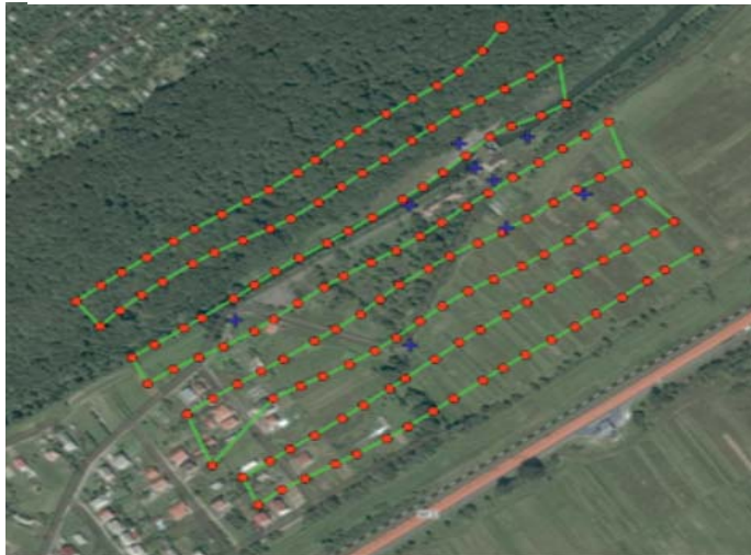
Рис. 2. Схема розміщення поодиноких знімків та контрольних точок
