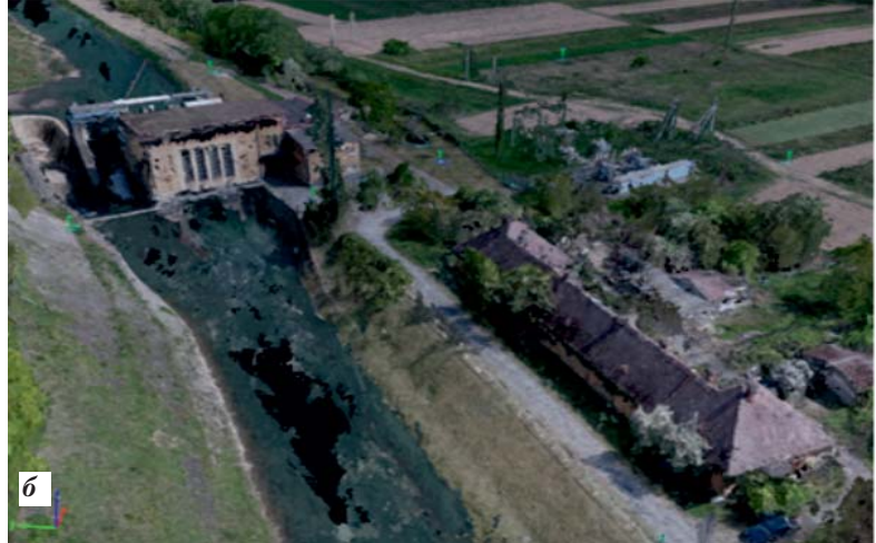
Рис. 3. Фрагмент хмари точок об'єкта знімання, а – сукупність точок, яка відображає територію Оноківської ГЕС та прилеглу територію, б – фрагмент сукупності точок що відображає інженерні споруди ГЕС.
