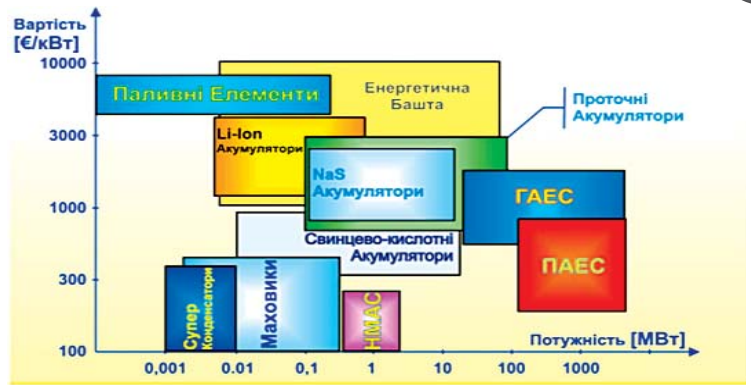
Рис. 3. Діапазони потужностей та капітальних затрат технологій акумулювання
