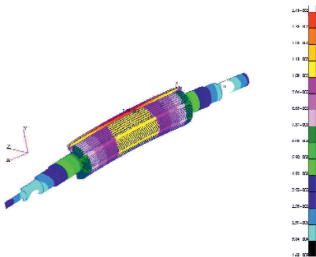
Рис. 2. Прогиб ротора при перегреве части зубцов
