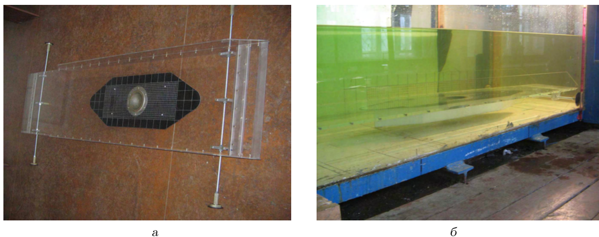
Рис. 1. Розташування півсферичної лунки на вимірювальній пластині (а) та їхнє місце знаходження у гідродинамічному лотку (б)
