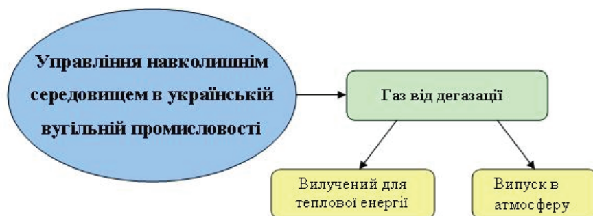
Рис. 7. Діаграма зв'язків на якій відображено процес дегазації гірничих виробок.
