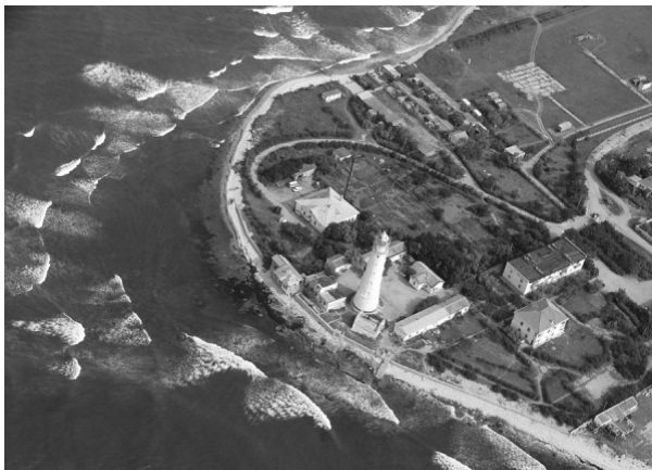
Рис. 3. Трансформация прибойных волн над подводной частью отмелого скального бенча у м. Тарханкут (фото: http://mejvodnoe.ru/wp-content/uploads/2012/07/tarhankut-foto-s-visoti7.jpg )
