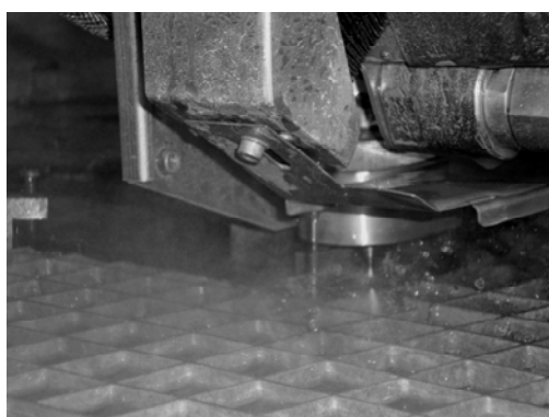
Рис. 3. Свечение, наблюдаемое между срезом калибрующей трубки и поверхностью обработки
