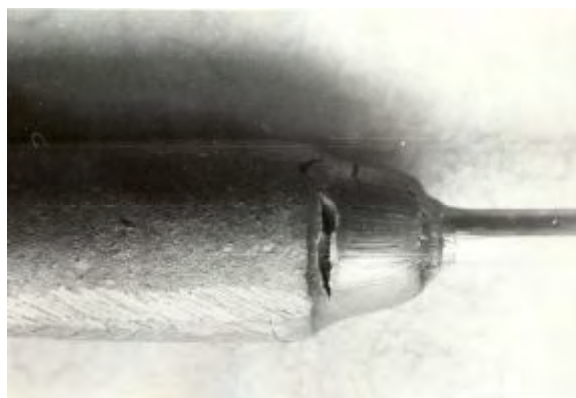
Рис. 7. Внешний вид прессостатка после экструзии никелевого образца
