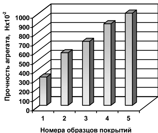
Рис. 4. Диаграмма влияния металлизации стеклоагрегатов порошков кубонита КР 125/100 металлическими покрытиями на их прочность: 1 – порошок кубонита, покрытый стеклом в системе PbO-ZnO-B_2O_3-SiO_2 ; 2 – порошок кубонита, покрытый смесью стекол в системах Na_2O-CaO-TiO_2-B_2O_3-SiO_2 и PbO-ZnO-B_2O_3-SiO_2 ; 3 – стеклоагрегаты из смеси стекол, металлизированные титаном (5,5% (по массе)); 4 – металлизированные титаном стеклоагрегаты из смеси стекол, покрытые медью (8% (по массе)); 5 – металлизированные титаном стеклоагрегаты из смеси стекол, покрытые никелем (12% (по массе))
