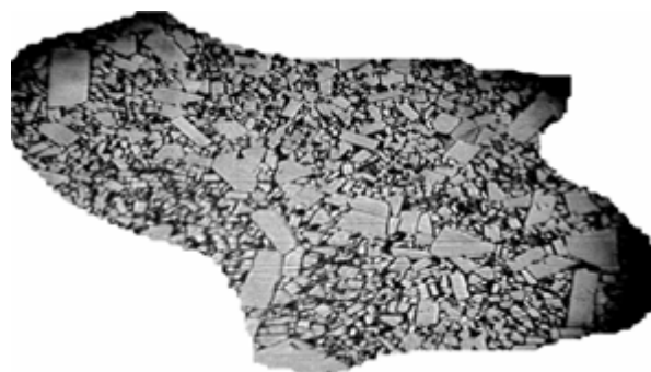
Рис. 4. Великі зерна карбіду вольфраму пластинчастої форми, розвернуті вздовж напрямку переміщення маси сплаву
