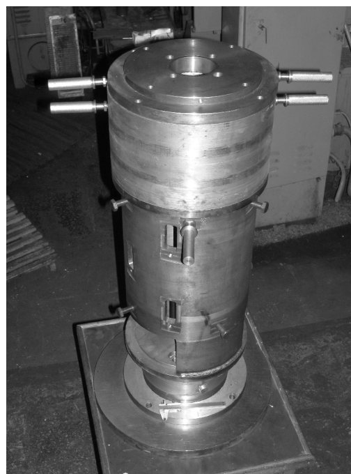
Рис. 3. Внешний вид и устройство для протягивания чугунных цилиндров на гидравлическом прессе
