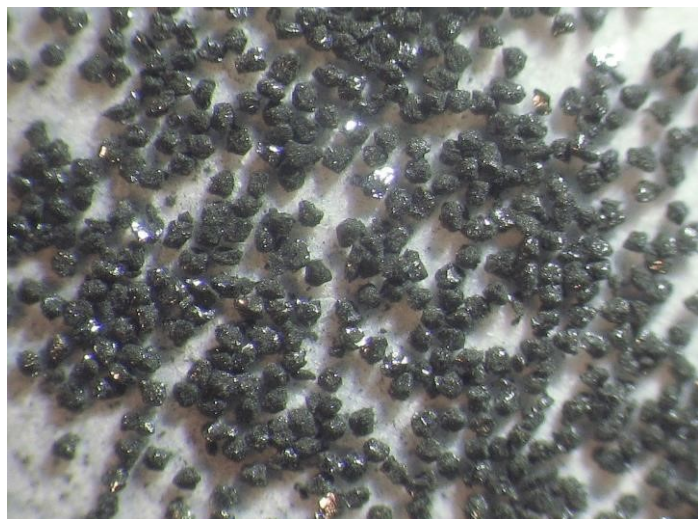
Рис. 1. Композиционный шлифпорошок К 160/125, изготовленный из компактов на основе шлифпорошков АС6 125/100 и микропорошков природного алмаза зернистости 3/0
