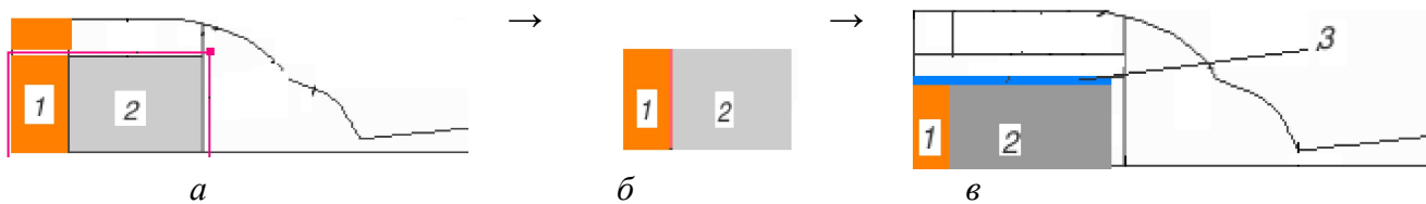
Рис. 6. Схема проведения экспериментов серии Г с применением контейнеров, оснащенных РЯ с нагревателем: а, б – в форме стержня; в – комбинированным
