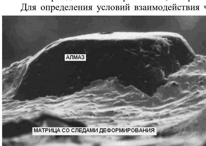
Рис. 2. Характерный вид износа материала матрицы алмазной буровой коронки
