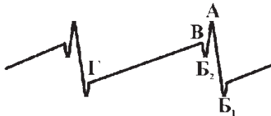
Рис.1. Схема распределения температуры по длине сваренной бесконечной заготовки [2]
