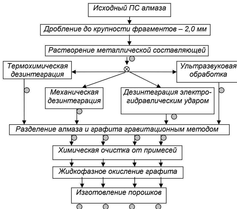
Рис. 1. Схема подготовки образцов для исследования (места отбора проб отмечены кружками)
