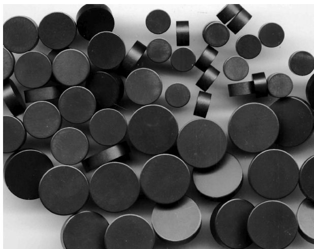
Рис. 4. Загальний вигляд різальних вставок круглої форми з композиту c\text{BN}/\text{Si}_3\text{N}_4 : RNMN 070300 (діаметром 7 мм); 090300T (діаметром 9,52 мм) і 120300T (діаметром 12,7 мм)
