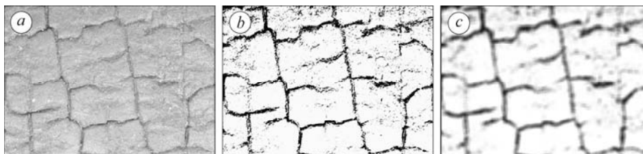
Рис. 4. Бінаризоване та відфільтроване вихідне зображення: a – вихідне багатоградацийне G ; b – бінарне B0 ; c – відфільтроване GF .
