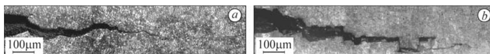
Рис. 4. Морфологія поширення тріщини за статичного навантаження на повітрі (a) та у водні (b).
