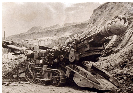
Рис. 4. Общий вид проходческого комбайна 2ПП конструкции Гипрорудмаша, оснащенного СВР, на испытательном полигоне
