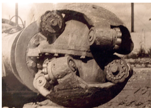
Рис. 3. Общий вид планетарного исполнительного органа проходческого комбайна 2ПП с консольным креплением СВР, оснащенных твердосплавными резцами
