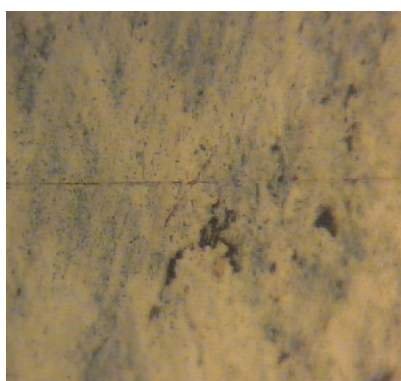
Рис. 2. Микроскопическое изображение поверхности образца, полученного свободным спеканием брикета из порошков меди, \times 2000
