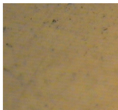
Рис. 2. Микроскопическое изображение поверхности образца, полученного свободным спеканием брикета из порошков меди, \times 2000
