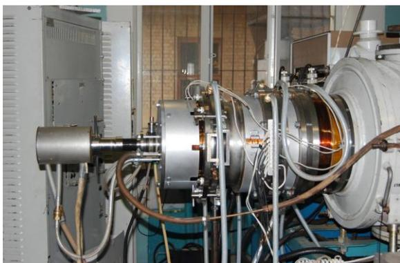
Рис. 1. Общий вид высокопроизводительного источника фильтрованной вакуумно-дуговой плазмы
