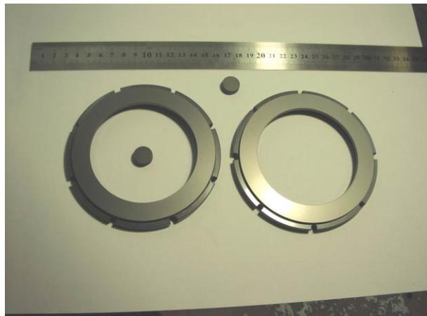
Рис. 5. Кольцевые элементы СГУ и образец-свидетель из карбида кремния с нанесенными АПП
