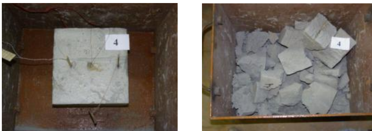
Рисунок 3 – Общий вид модели, расположенной во взрывной камере (а), и характер ее разрушения (б)
