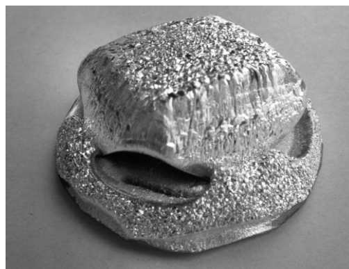
Рис. 4. Общий вид конденсата вверху колонки
