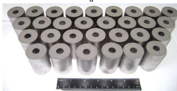
Рис. 1. Спечені формовки під пруток суцільного перетину (а) і під трубу (б)
