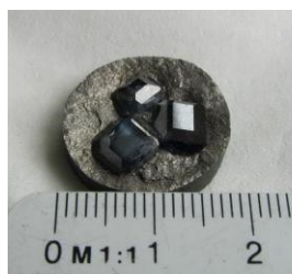
Рис. 4. Монокристаллы алмаза типа IIb, каждый массой около 3 карат в ростовом объеме ячейки высокого давления АД «Girdle 40»
